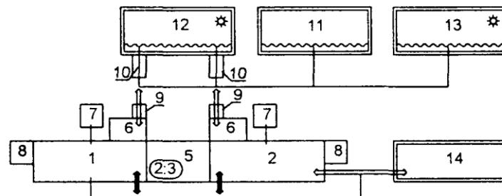
Схема 3 — с проходными кабинами для переодевания и хранением домашней одежды в гардеробной
