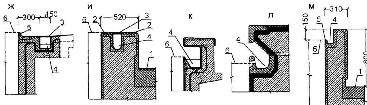
ж — переливной борт ванны; и — то же, ванны досугового назначения; к — борт ванны с переливным желобом; л — то же, из сборных элементов; м — то же, для терапевтических занятий;
