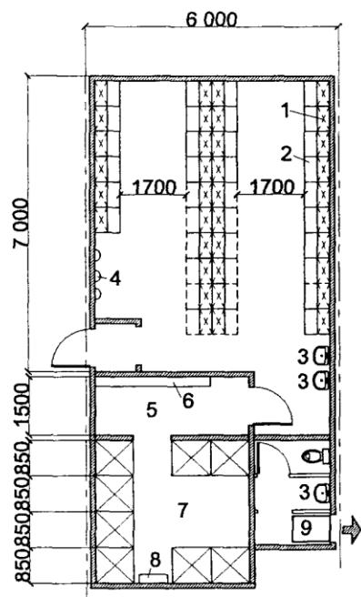
1 — двухъярусные закрытые шкафы; 2 — скамьи для переодевания; 3 — умывальник; 4 — сушилка для волос; 5 — преддушевая; 6 — вешалка для полотенец; 7 — душевая; 8 — стеллаж для мыла; 9 — ножной проходной душ
