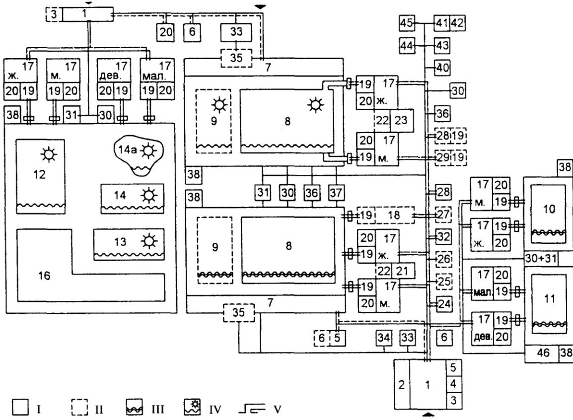
I — помещения и сооружения основного состава; II — помещения и сооружения дополнительного состава; III — крытая ванна; IV — открытая ванна; V — выплыв; VI — проходной ножной душ; VII — функциональная связь; VIII — движение занимающихся; IX — движение зрителей
