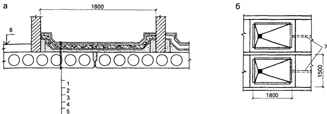
*a — разрез; б — план; 1 — керамическая плитка; 2 — прижимная железобетонная стена; 3 — четыре слоя гидроизола на мастике; 4 — цементная стяжка; 5 — плита перекрытия; 6 — уровень пола; 7 — трубы*
