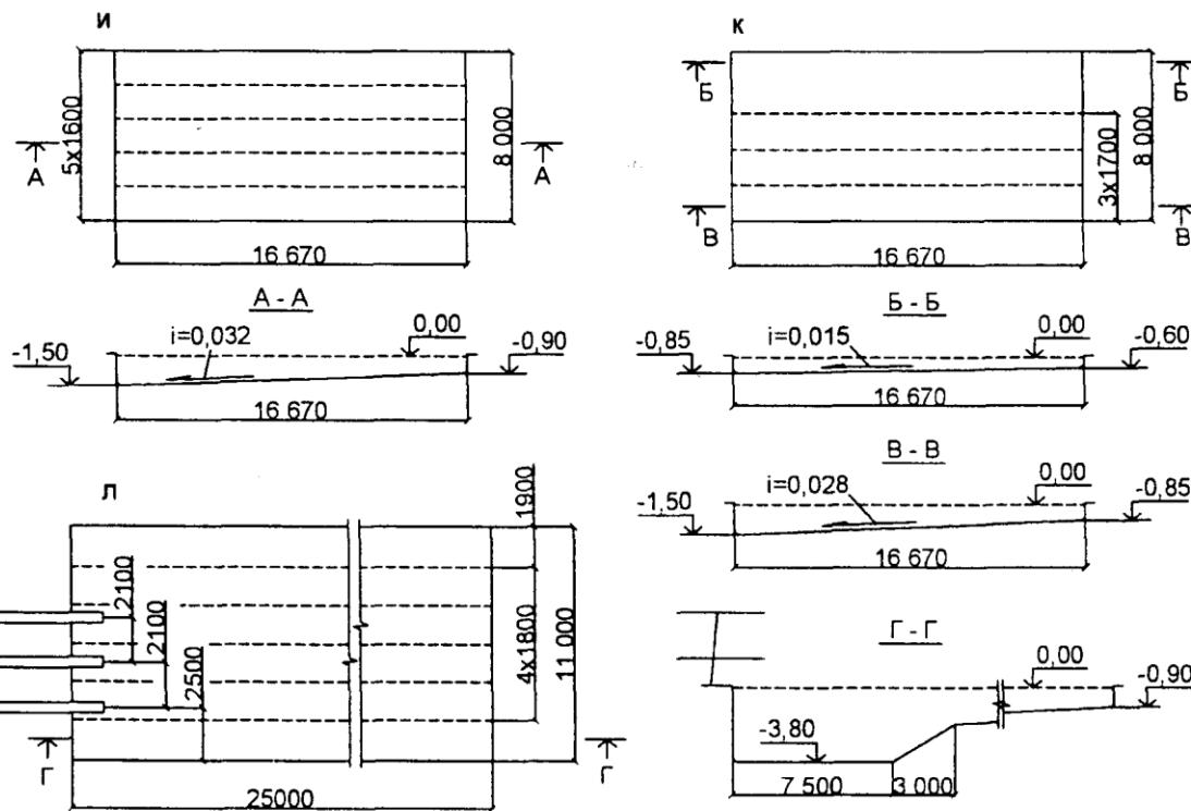
*и* — ванна 16,6×8 м; *к* — ванна 16,6×8 м с различной глубиной; *л* — ванна 25×11 м с прыжковыми устройствами
