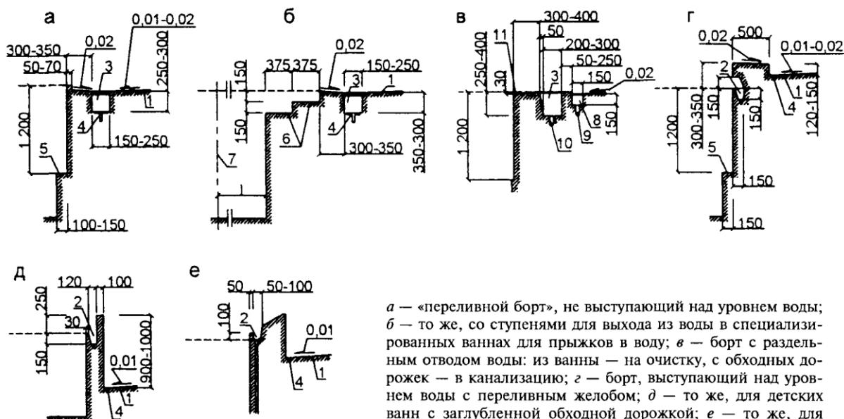
1 — обходная дорожка; 2 — переливной желоб; 3 — переливной желоб с решеткой; 4 — трап; 5 — уступ для отдыха; 6 — ступени для выхода из воды; 7 — вертикаль по переднему краю ближнего прыжкового устройства; 8 — грязевой желоб; 9 — отвод воды в канализацию; 10 — отвод воды на очистку; 11 — желоб
