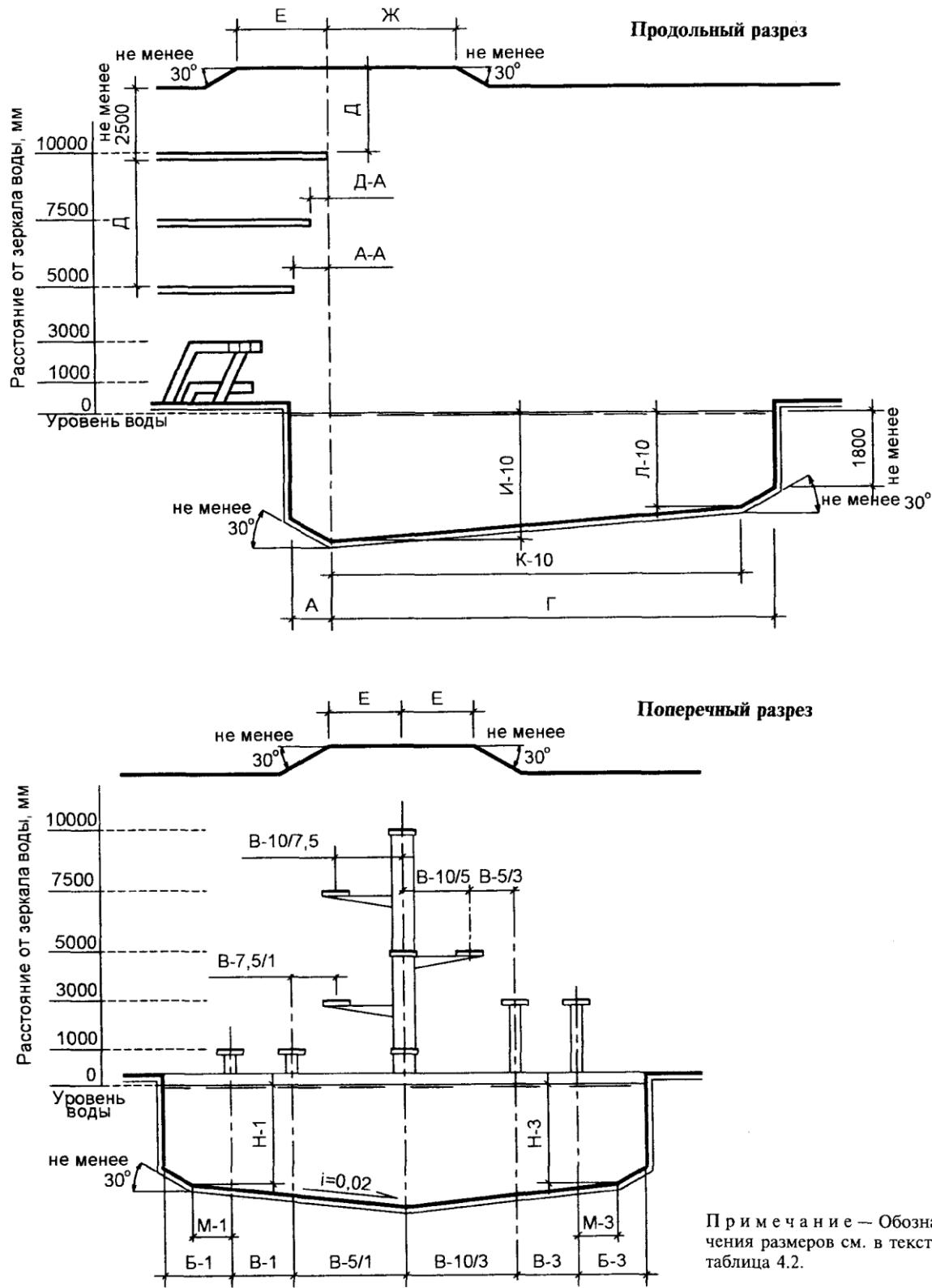
СХЕМЫ РАССТАНОВКИ УСТРОЙСТВ ДЛЯ ПРЫЖКОВ В ВОДУ
