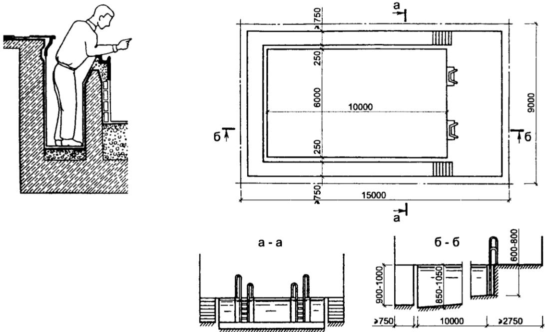
**Схема зала бассейна с ванной оздоровительного плавания размером 16,6×6,0 м
