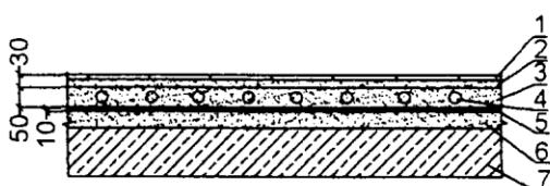
1 — керамическая плитка; 2 — цементная стяжка; 3 — слой песка; 4 — обогревающие трубы; 5 — гидроизоляция; 6 — цементная стяжка; 7 — плита перекрытия
