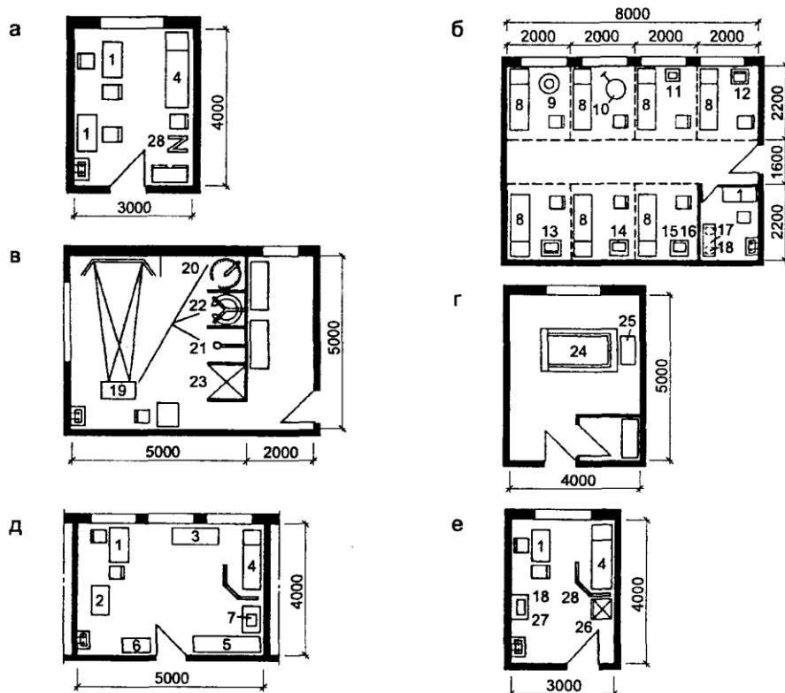
*а — кабинет врача (заведующего центром); б — кабинет электро- и светолечения; в — душевой зал; г — подводный душ-массаж; д — кабинет для проведения тестов с физической нагрузкой; е — процедурная;*
